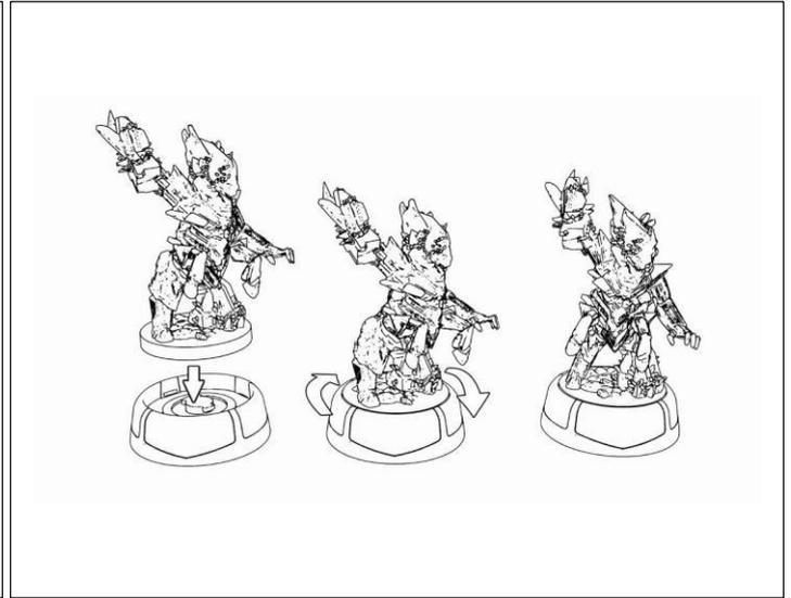
Setzen Sie den Boss auf den LED-Ring, indem Sie die Verriegelung ausrichten und ihn vorsichtig im Uhrzeigersinn drehen
