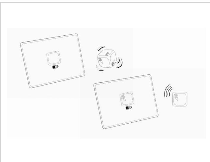
Wenn Sie dazu aufgefordert werden, verbinden Sie die Würfel, indem Sie sie schütteln
