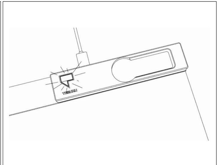
Stecken Sie das USB-C-Kabel in den Anschluss und verbinden Sie es mit einer USB-Stromquelle - Das Teburu-Logo beginnt zu blinken
