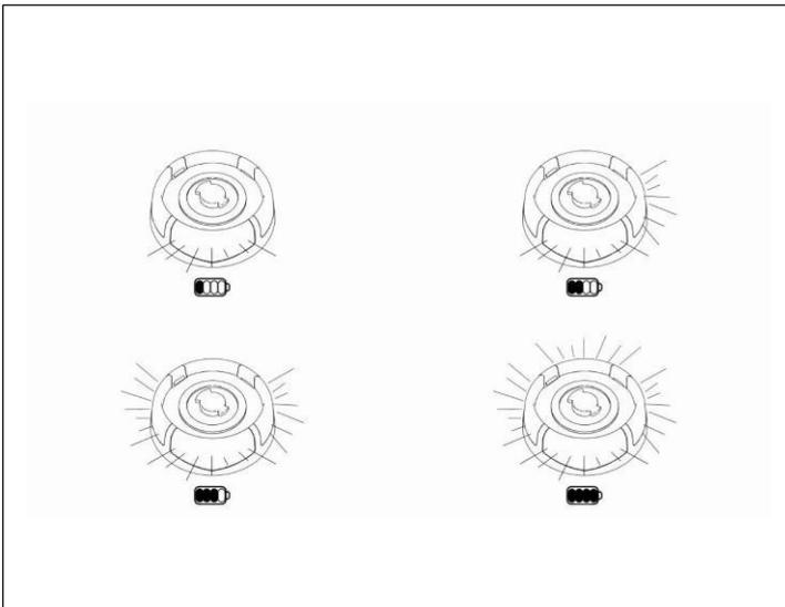
Der LED-Ring zeigt den Ladezustand der Batterie durch das Aufleuchten der LEDs an
