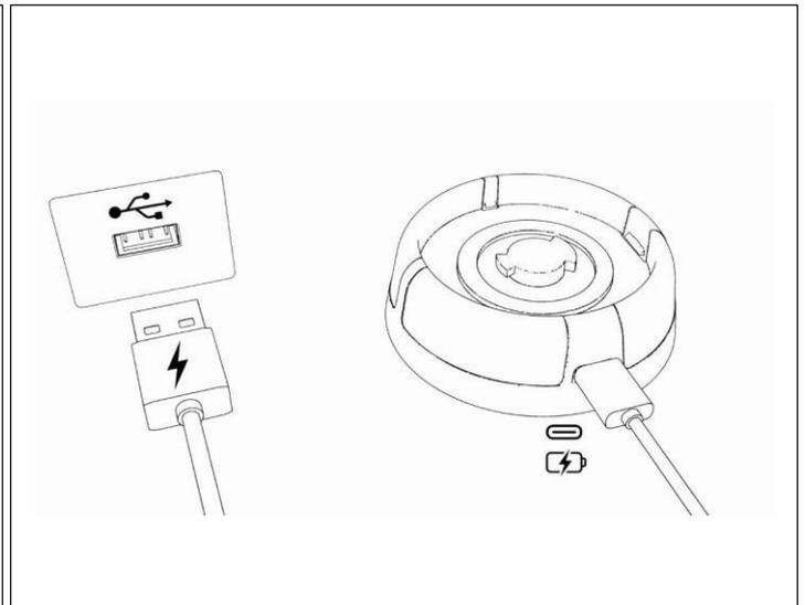
Um den LED-Ring aufzuladen, stecken Sie das USB-C-Kabel in den Anschluss und schließen Sie es an eine USB-Stromquelle an
